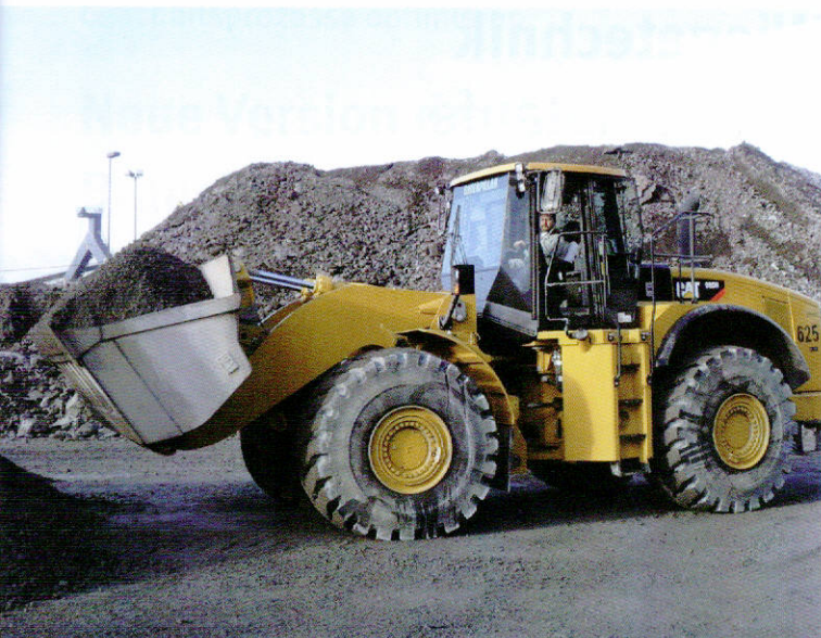
Zu den Aufgaben der Radlader gehört das Beladen von Lkw mit verkaufsfertiger Schlacke, die u.a. im Straßen- und Wegebau zum Einsatz kommt.
